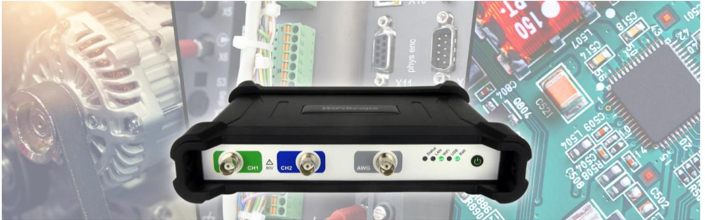
このクラス最高の高解像度低ノイズWiFiオシロスコープは、14ビットおよび16ビットの解像度、8ビットオシロスコープの256倍の振幅解像度を特長とし、チャンネルあたり最大3200万サンプルのスーパーズームを備えています。また、低歪み、高精度の40MHz任意波形発生器を搭載した最初のWiFiScopeでもあります。これにより、WiFiScopeWS5は、内蔵のファンクションジェネレータ、高解像度マルチメーターなどを備えた、最もパワフルでポータブルなバッテリー駆動の多用途WiFi PCオシロスコープになります...、SureConnectやCMIインタフェース、WiFi、有線LAN、SuperSpeed USB 3.0を介したユニバーサル接続など革新的なテクノロジーを組み込んでいます。
