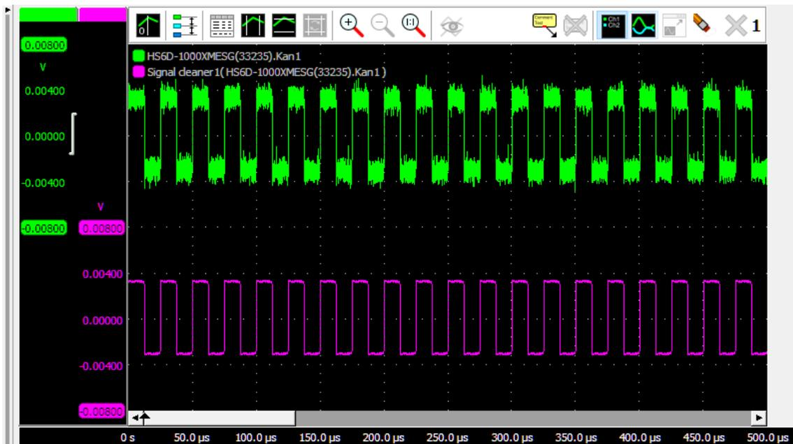
Figure 5: 信号クリーナ I/O 例
