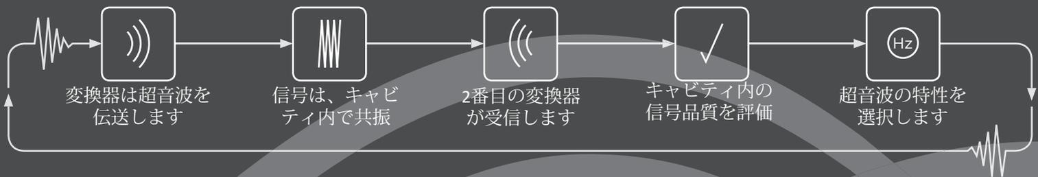
本センサーは、空気の温度、圧力や湿度の変化を補償します。小さなスペースの強い共振音波は測定が容易な大信号を提供します。ACU-RESは、他の超音波技術よりも40デシベル以上強い信号対雑音比（S/N比）を有しています。
