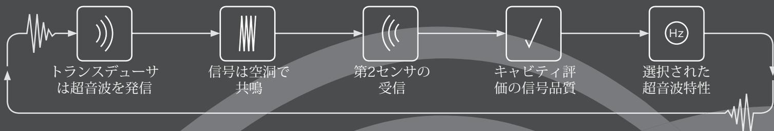
センサは、空気の温度、圧力または湿度の変化を本質的に補償します。小さな空間で強力な共鳴音波は測定しやすい大きな信号を提供します。アクレスは、他の超音波技術に比べて信号対雑音比が40dB以上強力です。
