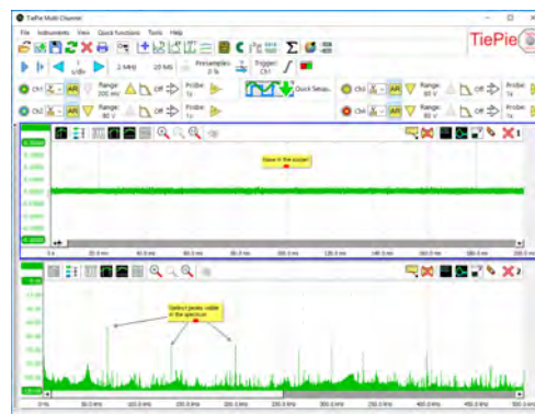
1000万ポイントのスペクトルと0~250MHzのリアルタイム帯域幅により、ピン幅が25Hz、パルス検出が2nsecになります。
