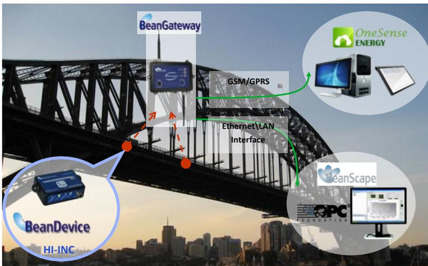
橋梁各部の傾斜測定
