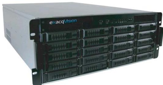
exacqVisionZ-シリーズ ハイブリッドサーバはエンタープライズレベルの監視カメラシステムに求められる性能を有します。Quad-core Xeon プロセッサ、4GBメモリ、デュアルギガビットNIC、電源の冗長性、及びHDDのRAID構成は全モデルに標準搭載されています。
