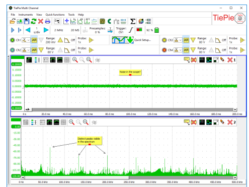
1000万ポイントのスペクトルと0~250MHzのリアルタイム帯域幅により、ビン幅は25Hzになり、パルス検出は2ナノ秒になります。
